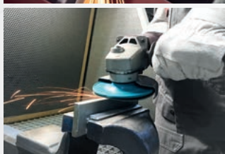
Preparação de cordões de soldadura
