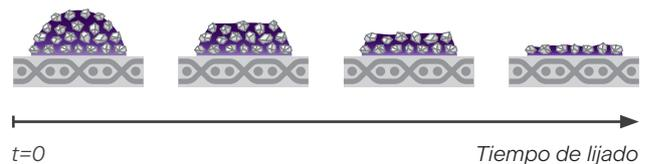
Los puntos XELERION constan de varias capas de muchos granos abrasivos afilados, que garantizan una alta calidad superficial y una alta tasa de arranque de material constante. Con una baja presión de contacto, los puntos se degradan de forma controlada y uniforme, exponiendo granos abrasivos afilados. Este comportamiento de degradación garantiza un lijado uniformemente afilado y una alta tasa de arranque de material, hasta el soporte de tela.
