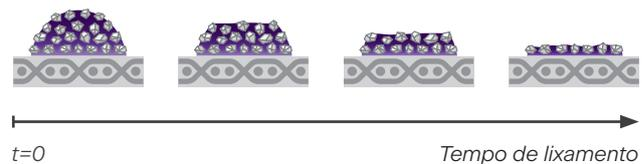
Os pontos XELERION são compostos por várias camadas de muitos grãos abrasivos afiados, que garantem uma elevada qualidade da superfície, bem como uma elevada remoção de material constante. Com uma pressão de contacto baixa, os pontos degradam-se de forma controlada e uniforme, expondo grãos abrasivos afiados. Este comportamento de degradação garante um lixado uniformemente afiado e uma elevada remoção de material contínua - até ao suporte do tecido.
