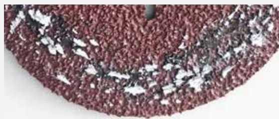
Os cavacos de alumínio obstruem um disco de fibra
