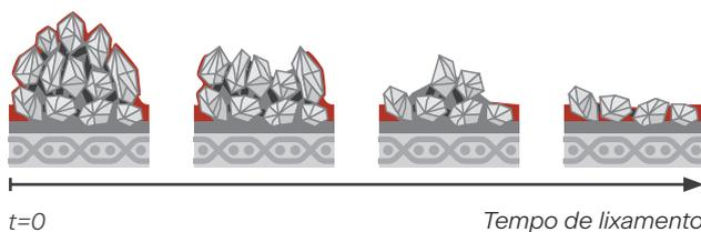
Graças a uma reserva de grãos otimizada em conjunto com propriedades de ligação melhoradas, as séries **VSM COMPACTGRAIN Plus** apresentam um padrão de desgaste mais uniforme. Isto significa que todo o granulado é usado até ao substrato.
