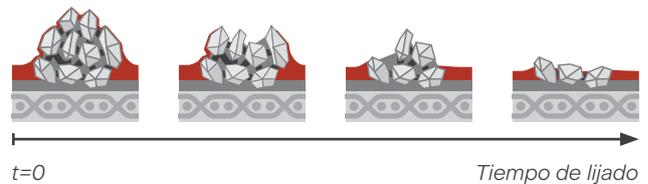
La serie **VSM COMPACTGRAIN** se fabrica íntegramente de gránulos que están compuestos por numerosos granos abrasivos. Los granos usados se desprenden por la fuerza corte, dejando expuestas las puntas de los granos no usados.
