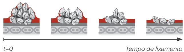
A série **VSM COMPACTGRAIN** é completamente feita de grânulos que são compostos por inúmeros grãos abrasivos. Os grãos usados são arrancados pelas forças de corte envolvidas, pelas quais as pontas do grão estão a ser expostas.
