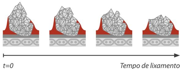
Os grãos abrasivos **VSM CERAMICS Plus** proporcionam efeito de auto afiação ainda maior no processamento de aços de alta liga e superliga sob elevada pressão de contato.
