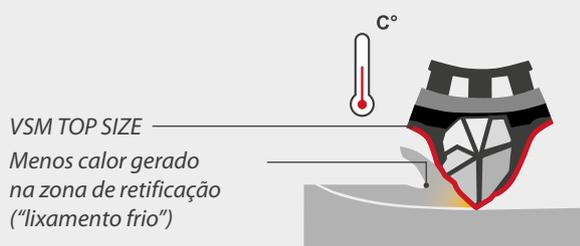
Para o processamento de aços inoxidáveis resistentes ao calor e metais não ferrosos, recomenda-se o uso do **VSM TOP SIZE**. A camada adicional de corte melhora o desempenho de corte, enquanto reduz a temperatura na zona de contacto. Isto prolonga significativamente a vida útil do abrasivo.
