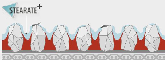
O **VSM STEARATE Plus** e o **VSM STEARATE** reduzem significativamente a adesão de cavacos ao processar metais não ferrosos, reduzindo também o empastamento do abrasivo. A vida útil é garantida e prolongada tão drasticamente que a excelente remoção de material é obtida mesmo após longos períodos de uso.
