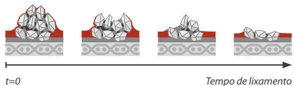
A série **VSM COMPACTGRAIN** é completamente feita de grânulos que são compostos por inúmeros grãos abrasivos. Os grãos usados são arrancados pelas forças de corte envolvidas, pelas quais as pontas do grão estão a ser expostas.
