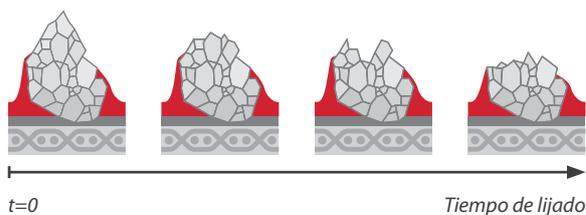
La estructura microcristalina de la serie **VSM CERAMICS** permite una fractura mucho más fina del grano y produce constantemente nuevas aristas afiladas.
