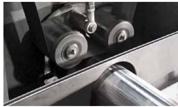
Lijado de cordones de soldadura longitudinales en tubo fabricado por soldadura.
