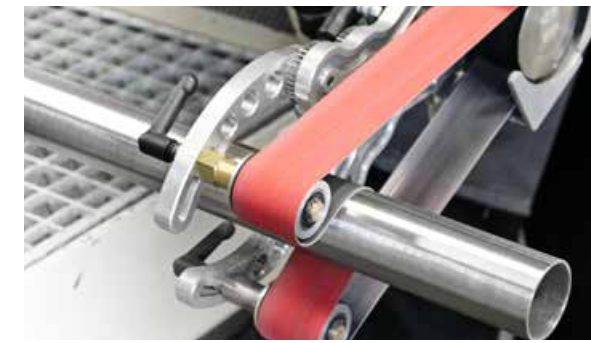
Esmerilado redondo de tubos y barras con lijadora de control manual
