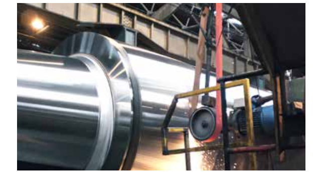
Esmerilado de rodillos en continuo
