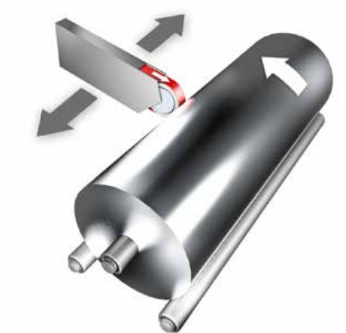
Esmerilado de rodillos en continuo
