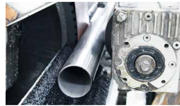
Lijado "Centerless" de tubos y barras.
